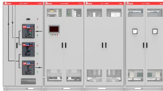
BW-DVR 系列动态电压恢复器是带有储能装置（系统）的补偿装置，其主要功能是有效防止暂态电能质量问题（电压暂降、电压骤升、供电短时中断等）对负载的影响，适用保护整条生产线的正常工作，可串联在系统供电线路和负荷之间（注：功率回路并联到负载前端）。
