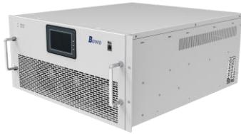
基于 IGBT 的 BW-SVG 静止无功发生器，由三大基本功能模块构成：检测模块、控制运算模块及补偿输出模块。其工作原理为由外部 CT 检测系统的电流信息，然后经由控制芯片分析出当前的电流信息，如 PF、S、Q 等；然后由控制器给出补偿的驱动信号，最后由电力电子逆变电路组成的逆变回路发出补偿电流。适用于冶金、煤炭、化工、有色、石化、半导体、汽车等行业。
